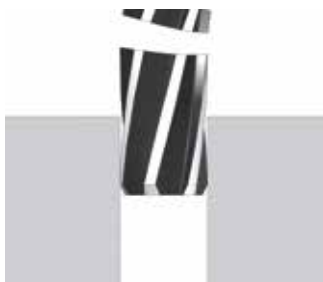
铰刀卡住和断裂
